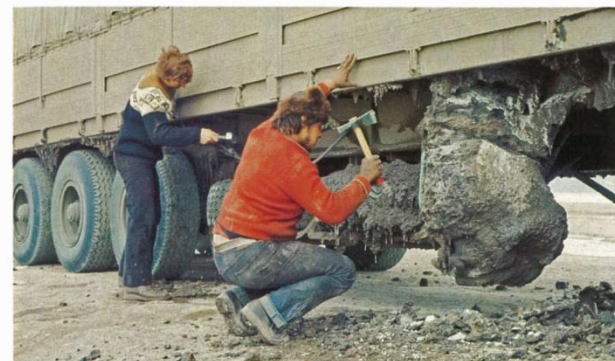
La glace s'accumule, bloquant la mécanique et alourdissant le véhicule.
