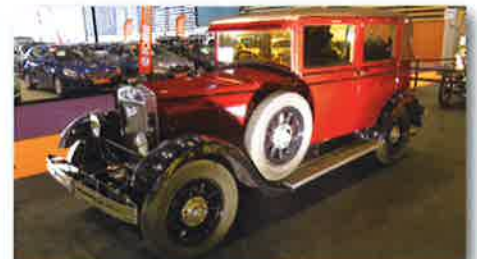
2016 – conduite intérieure Berliet, type VIC 1926 : moteur à essence 4 cylindres verticaux 65 x 112 / puissance 9 CV / boîte 4 vitesses AV et 1 AR / freins à pied à tambours sur les quatre roues / à main à tambours sur les roues AR / suspension par ressorts à lames semi-elliptiques / vitesse 48 km/h à 1 900 tr/mn.
