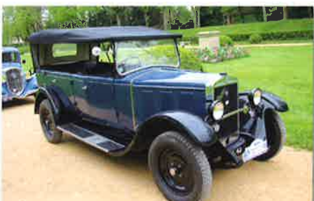
Torpédo Berliet VII, 1932 de Paul Dumas : ce modèle a été réceptionné aux Mines en 1930. Moteur 4 cyl. 65x111,7 / 1.500 l. de cylindrée / 9 CV / boîte 4 vitesses AV et 1 AR.
