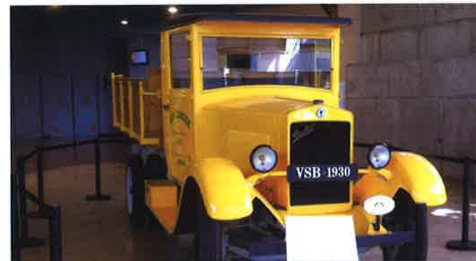
Camionnette Berliet VSB, 1930 : PTC 3 200 kg / moteur 4 cyl. 90x130 / 3,3 l. de cylindres / boîte 4 vitesses AV + 1 AR / transmission par cardans / benne basculante à crémaillère commandée par manivelle.
