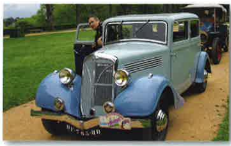
« Conduite intérieure » Berliet 944, 1935 de Joseph Combarmond : moteur 4 cyl. 68x111,7 à soupapes en tête / 1.600 l. de cylindrée / boîte synchronisée à 4 vitesses AV (dont 3 ème et 4 ème silencieuses) + 1 AR / équipement électrique complet.
