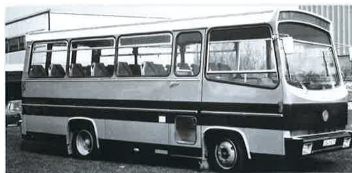
Autobus électrique Sovel, type AS 9 B carrossé par Currus, d'une autonomie de 60 à 80 km.
