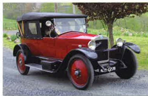
Torpédo Berliet type VH, 1922 : moteur 4 cyl. 80x130 / carburateur Zénith 30 HAK / mise en marche électrique / direction à droite / boîte 3 vitesses AV + 1 AR / roues pleines Berliet, à jantes amovibles. Acquis en 2015 par Yves Berliet, cette voiture, en bon état, a fait l'objet d'une révision d'ensemble. Cette sortie était une première.
