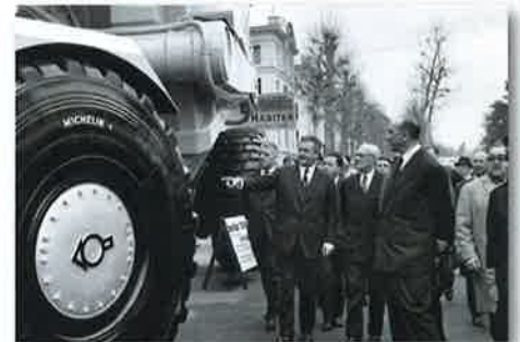
1965 – Paul Berliet présente, le 20 mars, le dumper articulé 4x4 TX40 : PTC 84 t. / vitesse maxi 72 km/h / moteur électrique / boîte mécanique à 2 vitesses et réduction dans la roue / suspension oléopneumatique. À droite, Louis Chaudenson, directeur des fabrications Berliet-Poids Lourds.
