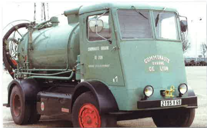
Sovel type EM, 1951 du « Service Assainissement » de la Communauté Urbaine de Lyon (COURLY) qui l'a offert à la Fondation Berliet en 1987. Vitesse : 24 km/h à vide et 20 km/h à pleine charge. Les derniers camions Sovel ont été utilisés à Lyon en 1984.
